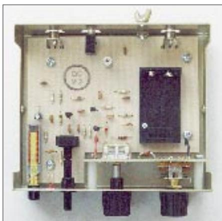
**Bild 3:** Innenansicht der AT100. Unten befinden sich von links nach rechts: Schalter Bypass, Potentiometer Gain, Drehkondensator (Quetscher) und der Bandschalter. Rechts auf der Leiterplatte ist die Halterung für die 9-V-Blockbatterie zur wahlweise internen Stromversorgung angebracht. Oben mittig der Stehbolzen für den Teleskopstab.
