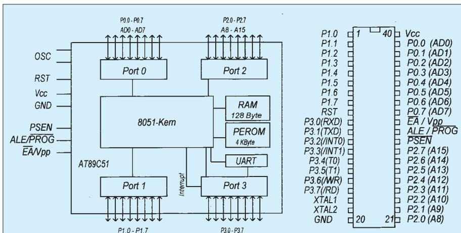
Bild 3: Bei den Typen AT89C51 und 52 erkennt man die Kompatibilität zum Standard-8051. Beim AT89C52 wird der dritte Timer über Port 1 (P1.0=T2 und P1.1=T2.EX) angeschlossen.
