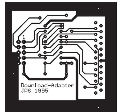
Bild 3 : Leiterplattenvorschlag für den Adapter
