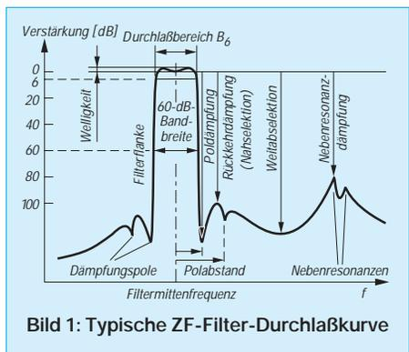
Bild 1: Typische ZF-Filter-Durchlaßkurve
