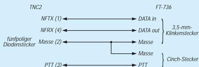
Bild 12: Verbindungen zwischen TNC 2 und einem FT-736
