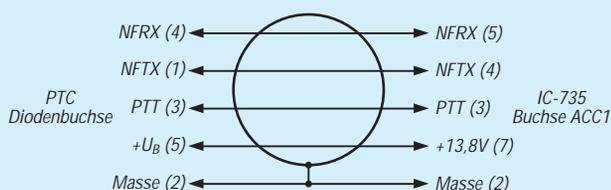
Bild 11: Verbindungen zwischen PTC und einem IC-735
