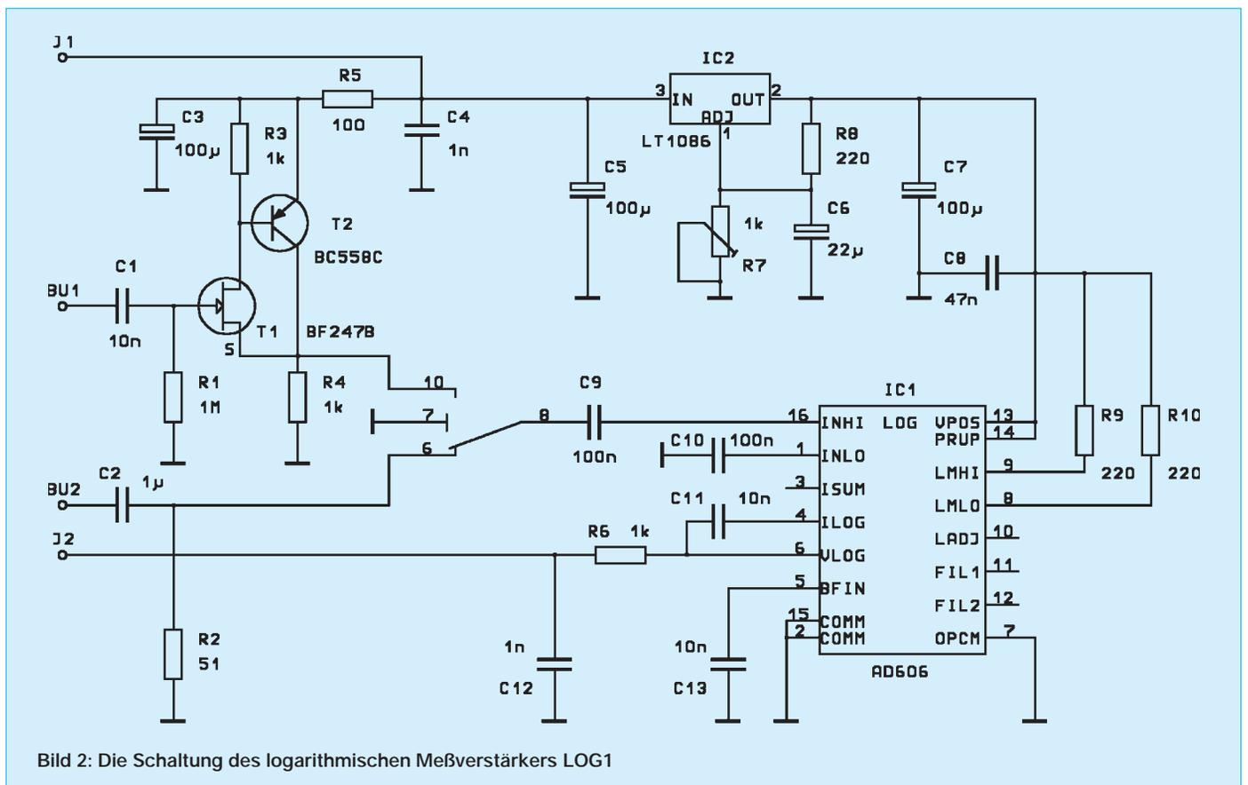
Bild 2: Die Schaltung des logarithmischen Meßverstärkers LOG1
