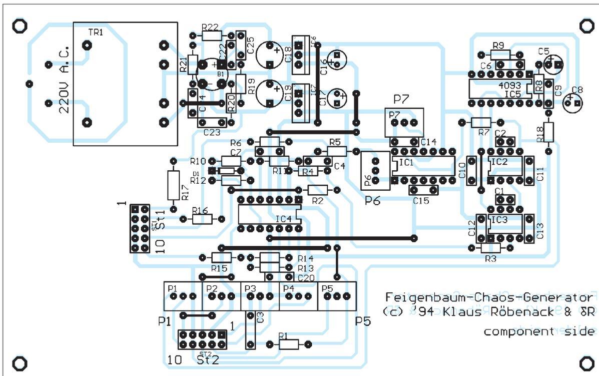
Bild 3: Bestückungsplan (Leiterzüge sind als Drahtbrücken ausführbar)
