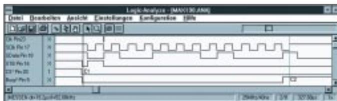
Bild 2: Timing der seriellen Schnittstelle des MAX190
