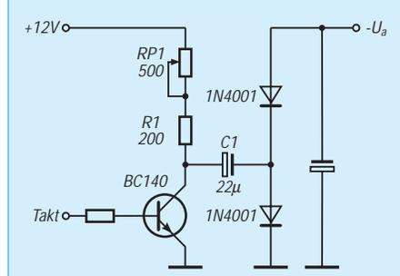
vorhanden, so könnte ein Taktgeber NE 555 einen entsprechenden Takt erzeugen. Ist der Transistor taktmäßig leitend, wird die Ladung des 22- $\mu$ F-Kondensators durch die obere Diode auf den 47- $\mu$ F-Kondensator geschaltet. Der leitende Transistor legt die positive Seite des Elektrolytkondensators an Masse.
