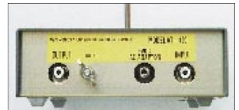
**Bild 2:** Rückansicht die AT100. Von links nach rechts: Ausgangsbuchse Ausgang (Cinch), Masseschraube, Buchse für externe Stromversorgung (9 V Gleichspannung), Eingangsbuchse (Cinch).
