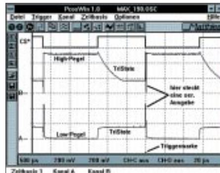
Bild 3: CS\*, SCLK und SData, langsame Pegelmessung
