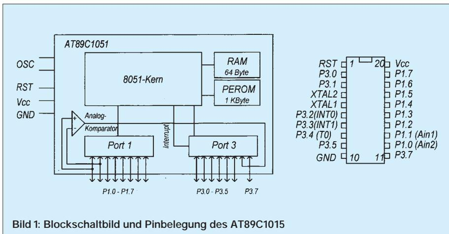
Bild 1: Blockschaltbild und Pinbelegung des AT89C1051
