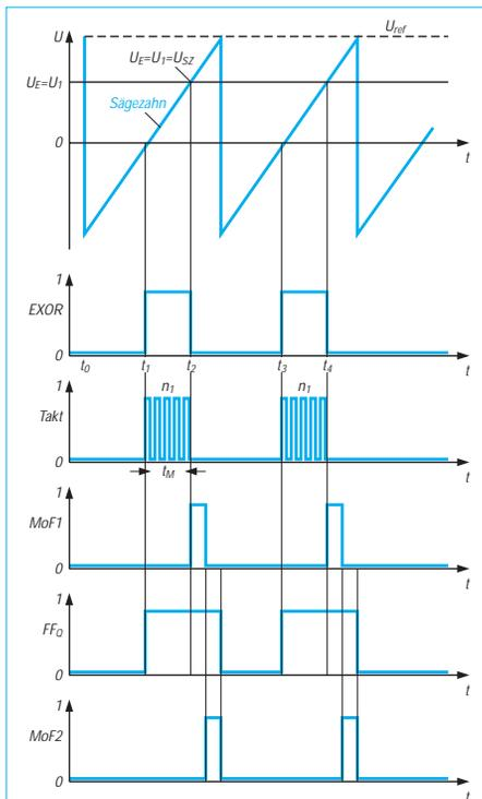
Bild 3: Signal-Zeit-Plan zur Schaltung nach Bild 2.
