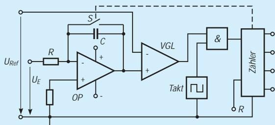
Bild 1: Prinzipschaltung eines A/D-Umsetzers nach dem Sägezahnverfahren.
