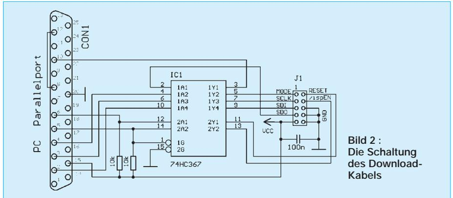
Bild 2 : Die Schaltung des Download-Kabels
