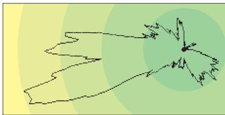
„Azimutales Erfolgsdiagramm“ von DL0WSW, JO60US, beim IARU-UHF/SHF-Contest auf 70 cm (erreichte Kilometerpunkte nach Richtungen; der Öffnungswinkel der Antennen betrug 15°)
