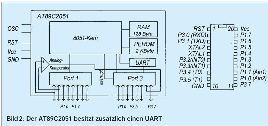
Bild 2: Der AT89C2051 besitzt zusätzlich einen UART
