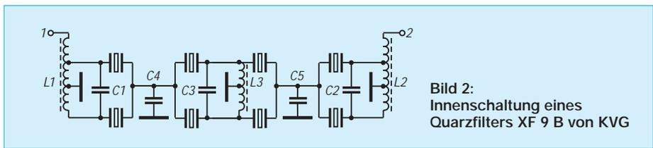
Bild 2: Innenschaltung eines Quarzfilters XF 9 B von KVG
