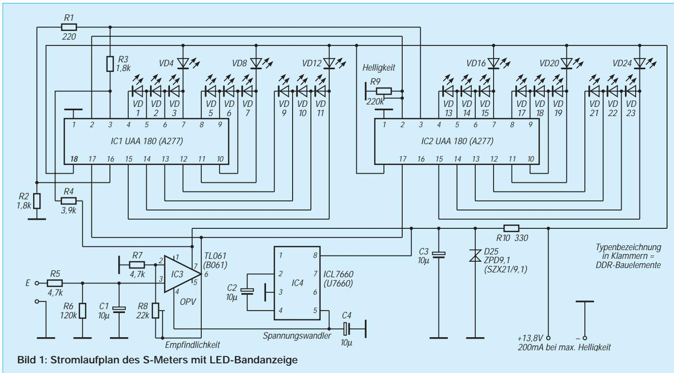
Bild 1: Stromlaufplan des S-Meters mit LED-Bandanzeige
