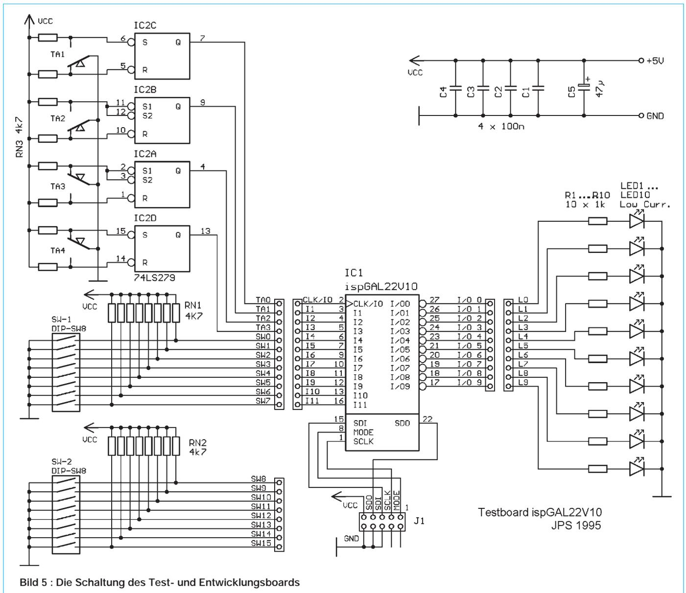
Bild 5 : Die Schaltung des Test- und Entwicklungsboards
