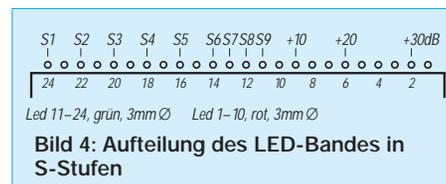
Bild 4: Aufteilung des LED-Bandes in S-Stufen
