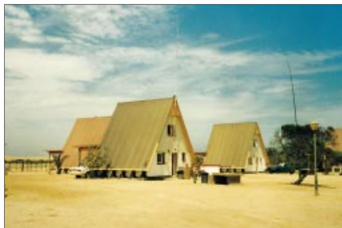
Blick auf den verdrahteten Bungalow: über ihm ein Dipol für 160 m, direkt am Haus die Vertikal und am Baum eine GP für 80 m.
