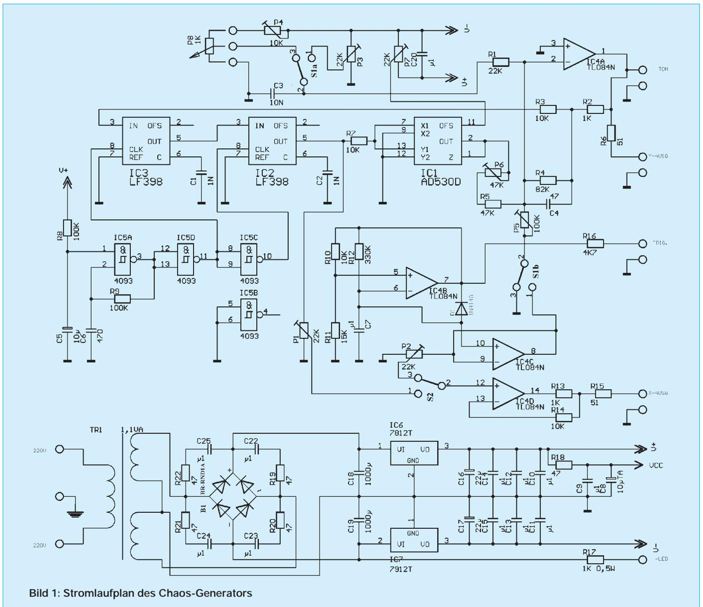
Bild 1: Stromlaufplan des Chaos-Generators
