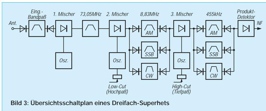
Bild 3: Übersichtsschaltplan eines Dreifach-Superhets
