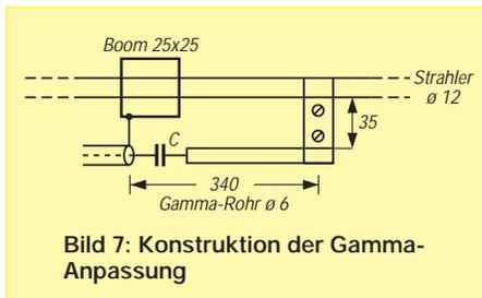
Bild 7: Konstruktion der Gamma-Anpassung
