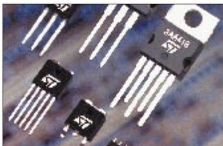
Der Spannungsverlust beträgt typisch 0,45 V, die Ruhestromaufnahme 0,05 mA im Aus- und 0,5 mA im Ein-Zustand. Sämtliche Bausteine verfügen über eingebaute Strombegrenzung, einen Überhitzungsschutz und bieten eine Versorgungsspannungsunterdrückung von typisch 80 dB. Angeboten werden zwölf Versionen mit verschiedenen festen Ausgangsspannungen zwischen 1,25 und 5,2 V, die es in DPAK-, TO-220- und Pentawatt-Gehäusen gibt. Letztere haben einen Anschluß für Shutdown-Funktion.
