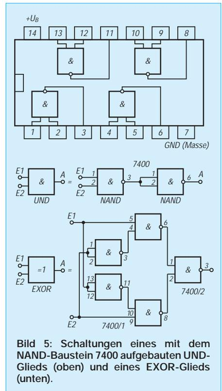
Bild 5: Schaltungen eines mit dem NAND-Baustein 7400 aufgebauten UND-Glieds (oben) und eines EXOR-Glieds (unten).
