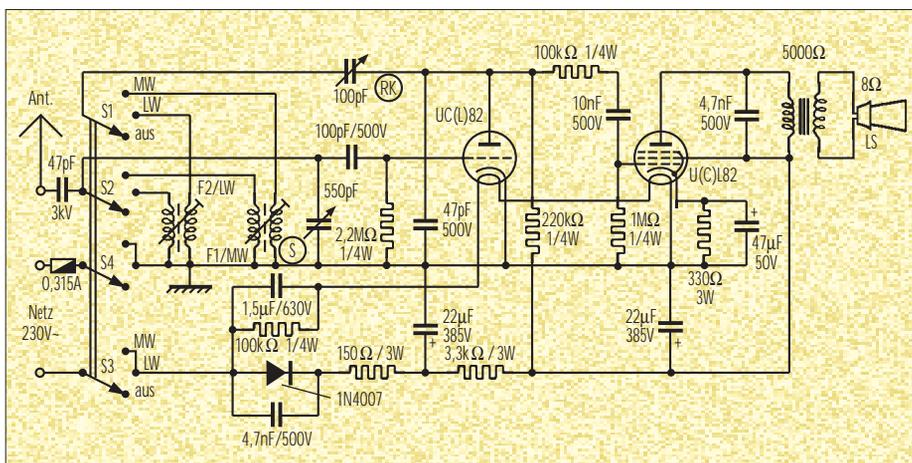
barschaftlichen Beziehungen. Bei starker Rückkopplung, also wenn das Audion als Oszillator arbeitet, strahlt der 0-V-1 über die Antenne etwas HF ab, die den Empfang beim Nachbarn stören kann. Aber wer hört heute noch Mittelwelle?
