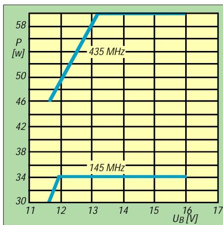
Bild 2: Die Sendeleistung in Abhängigkeit von der Betriebsspannung in der Leistungstufe High, gemessen auf beiden Bändern
