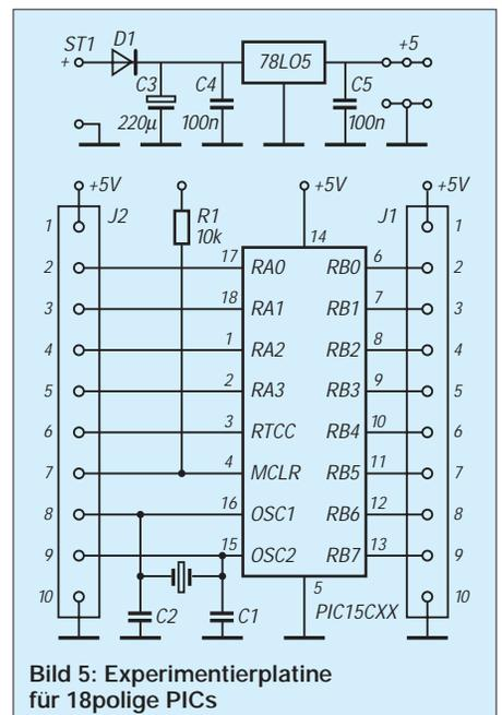
Bild 5: Experimentierplatine für 18polige PICs
